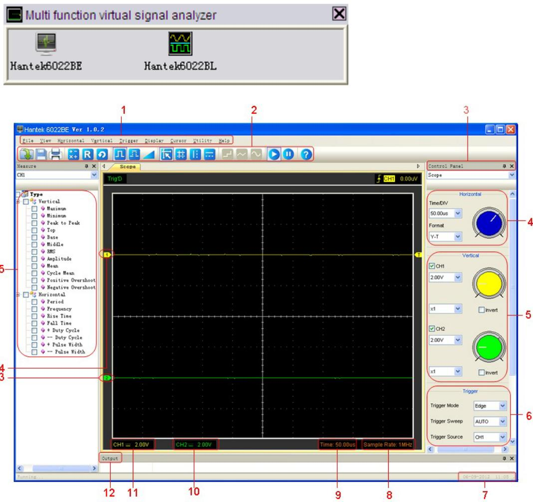
Помимо отображения динамических сигналов на экране будет указана подробная информация по сигналам, а также настройки управления осциллографа.
