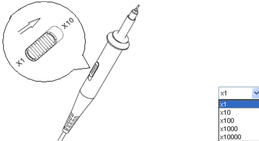
Присоедините наконечник щупа и контакт заземления к компенсатору разъема щупа. Через несколько секунд отобразится прямоугольный сигнал (Примерно 1КГц, 2В от пика до пика).
