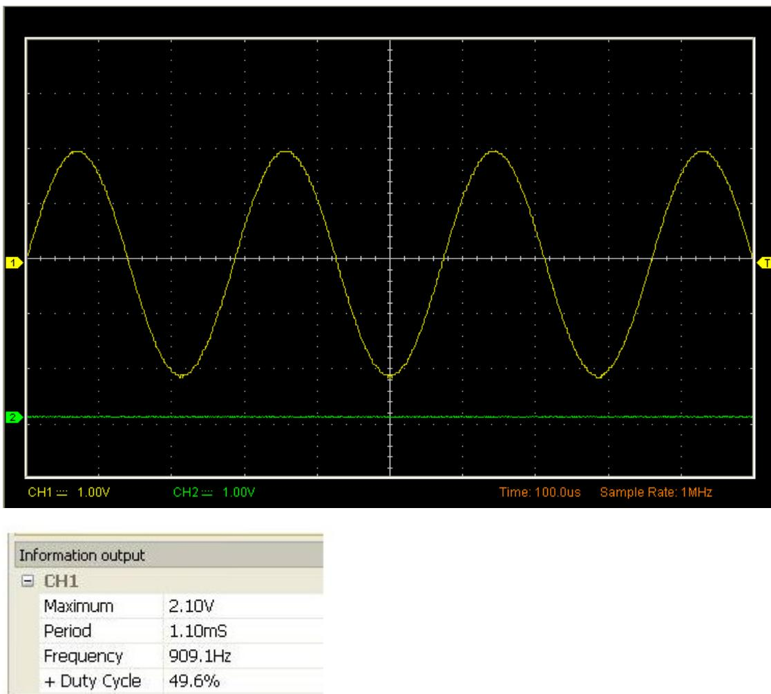
**Примечание:** Результаты автоматических измерений отображаются внизу экрана. Одновременно может отображаться максимум 8 результатов. Если отсутствует место для отображения новых измерений, то они сдвигают старые результаты влево, за пределы экрана.
