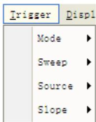
Синхронизация обозначает тот момент, когда осциллограф запускается для получения данных и отображения сигнала. Когда запуск настроен правильно, он может преобразовывать нестабильные изображения или пустой экран в отчетливый сигнал.
